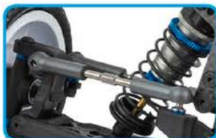
Überarbeitete Kugelpfannen und Spurstangen für präzise Anpassungen und Haltbarkeit
