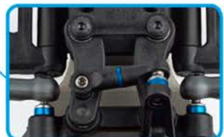
Rückwärts-gerichtetes Lenkgestänge ermöglicht mehr Platz für die Elektronik-Montage
