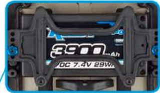
Einstellbare Batteriehalterung ermöglicht die Verlagerung des Schwerpunktes
