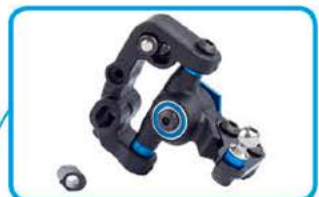
Einteilige Lenkhebel mit angeschraubter Ackermann-Platte
