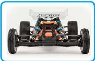
Kohlefaser-Dämpferbrücken und Flügel-Frontschwingen mit drei Positionen zur Dämpferbefestigung
