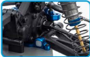
Schwingenhalter und obere Lenkerhalterung aus leichtem und haltbarem Aluminium
