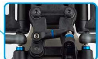
Transmisión de la dirección inversa, proporciona más espacio para los componentes electrónicos.
