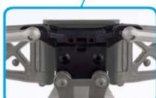
Barras estabilizadoras delantera y trasera integradas, para un ajuste más sencillo (barras estabilizadoras no incluidas).
