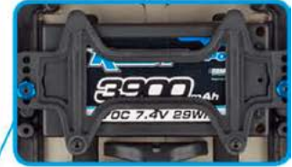
Fijación ajustable de la batería, permite ajustar el centro de gravedad.
