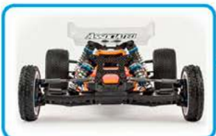
Soporte de amortiguadores de carbono reforzado y trapecios delanteros curvados con tres posiciones de anclaje de amortiguadores.
