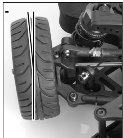
- Nachspur Toe Out Ouverture Convergencia negativa
