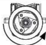
Engine rotation direction Drehrichtung des Motors
