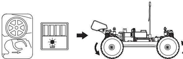
Die Richtung in welche der Gashebel der Fernsteuerung als erstes bewegt wird, wird als Vorwärts festgelegt
