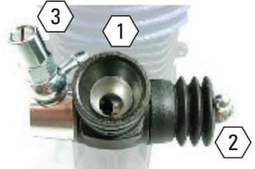
**Standgasschraube (#1):** Bestimmt die Luftmenge bei geschlossenem Vergaser und dient als mechanischer Anschlag für den Gasschieber. Drehen Sie im Uhrzeigersinn für höhere und gegen den Uhrzeigersinn für niedrigere Leerlaufdrehzahl. Der Vergaser sollte bei Neutralstellung des Gasservos 0.5-1.0mm geöffnet sein.
