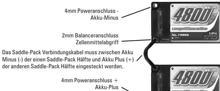
Das Saddle-Pack Verbindungskabel muss zwischen Akku Minus (-) der einen Saddle-Pack Hälfte und Akku Plus (+) der anderen Saddle-Pack Hälfte eingesteckt werden.
