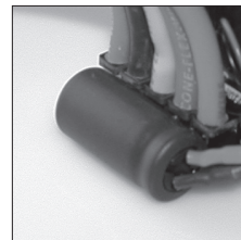
Montieren Sie den Power-Kondensator an einer crashgeschützten Stelle. Am besten direkt unter den Lötaschen (siehe Bild) und befestigen diesen mit doppelseitigem Klebeband.
